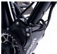
Wartungsarm und unverwüchlich: Pinion C 1.12-Getriebe.
