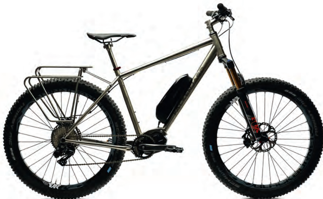
Clou: Hinterbau asymmetrisch, Hinterrad symmetrisch gespeicht.
