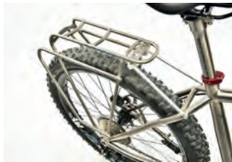
Clou: Hinterbau asymmetrisch, Hinterrad symmetrisch gespeicht.
