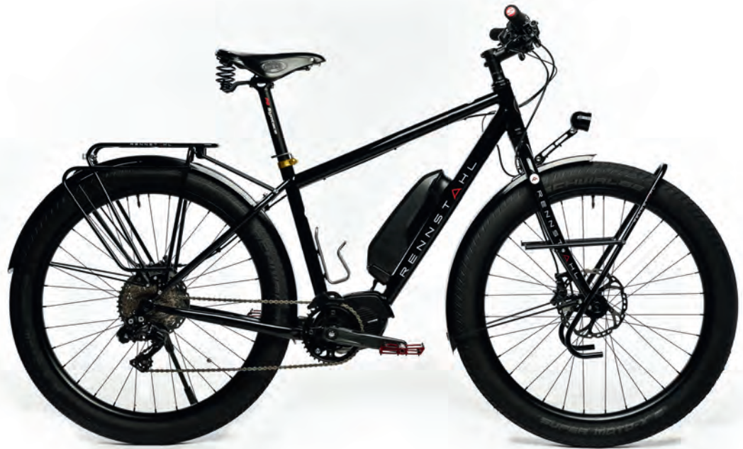
Ballonreifen, Starrgabel, hohes Frontlicht (kein Reifen-Schatten).
