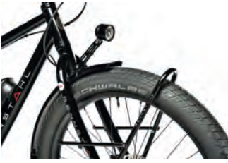
Ballonreifen, Starrgabel, hohes Frontlicht (kein Reifen-Schatten).
